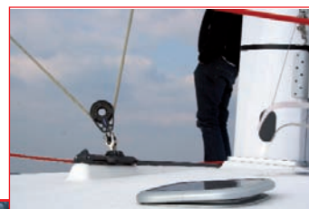
Pas de chariot de grand-voile ; et solent auto vireur, les éléments d'un virement de bord sans soucis.
