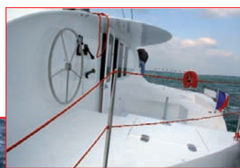
Le passage en arrière de la casquette, pour se rendre sur le pont, est un peu juste ; et les filières à cet endroit au moins mériteraient d'être rehaussées.
