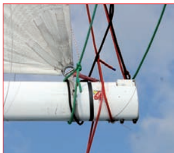
L'écoute de grand-voile, dépourvue de chariot, est constituée d'un simple brin en Dyneema. Les réglages se peaufinent avec un barber.
