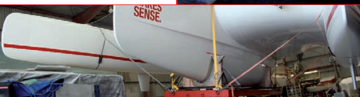
On remarque les deux ailerons fixes, très courts mais à fort allongement (le saumon sous la coque centrale est caché).
